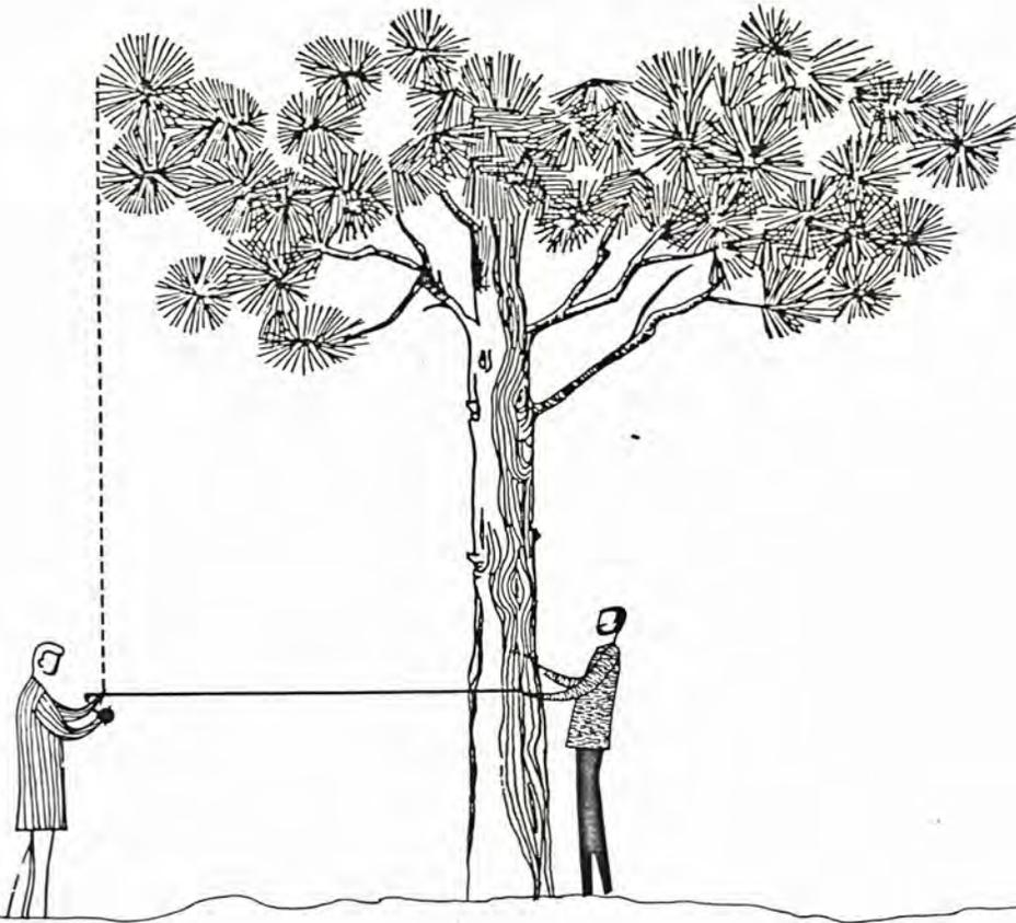
FIGURA 18: Esquema da medição de diâmetro da copa no campo.
