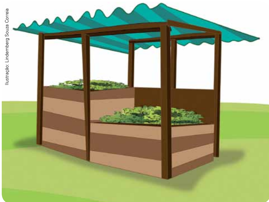
Composteira rústica com divisórias de 1,5 x 1,5 x 1,5 metros.
