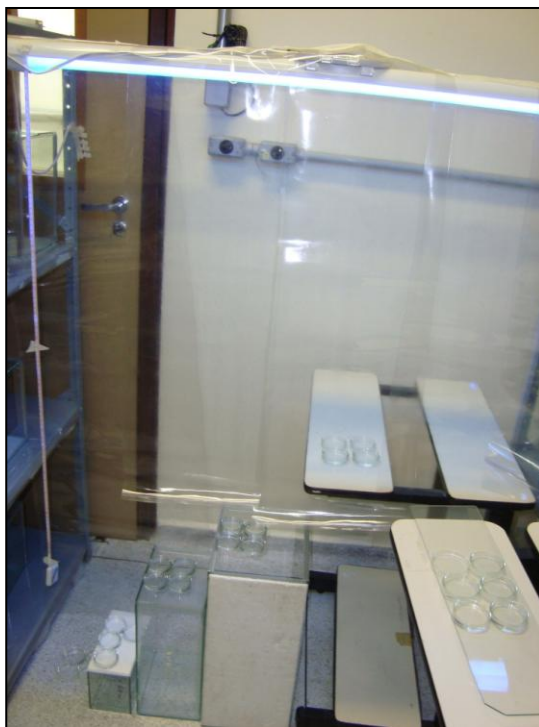
III) Condições experimentais em bioensaio com Daphnia , exposição à diferentes distâncias das lâmpadas de radiação UV.
