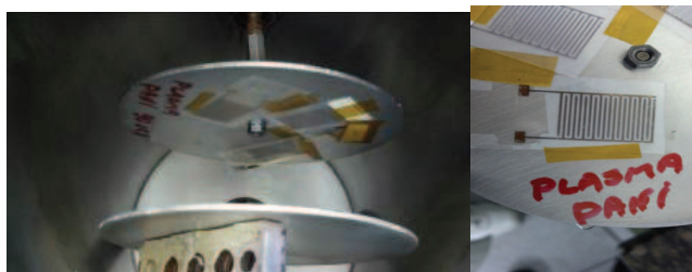
Figura 4. (a) Montagem do aparato do equipamento de plasma com o biossensor acoplado na parte superior anodo, (b) Detalhe do filme de PANI - superfície esbranquiçada sobre o biossensor.
