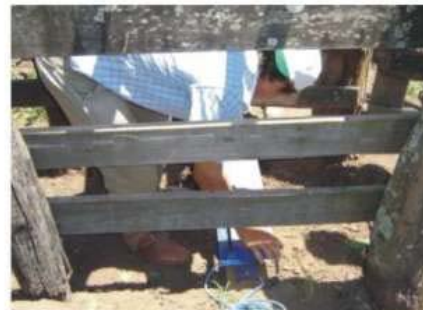
Figura 2. Colocação das barras de pesagem no vão do brete.
