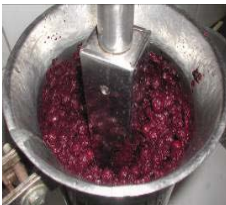
Figura 9. Despolpamento dos frutos do açaizeiro em despolpadora elétrica vertical.
