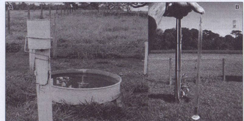
Figura 1. (A) Tanque classe A e pluviômetro, utilizados no manejo de irrigação (método EPS); (B) evaporímetro de Piché, que pode ser utilizado em substituição ao tanque do tipo classe A.
