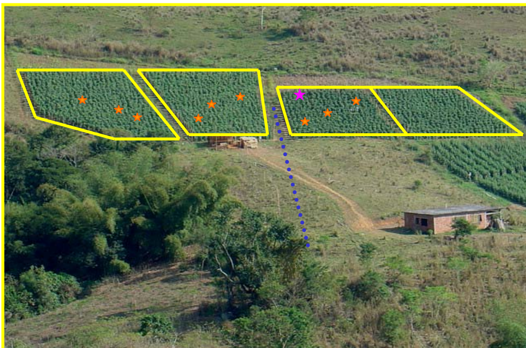
Figura 27 – localização dos sensores GMS, termopluviógrafo e linha principal de adução do sistema de irrigação.
