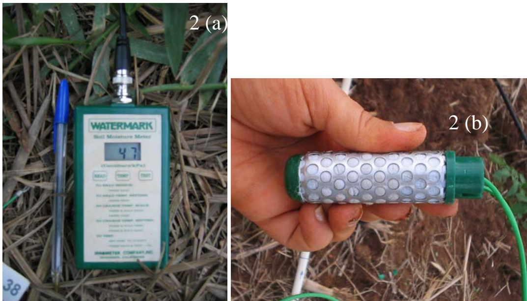
Figura 2a e 2b: Leitor watermarker portátil da Irrometer inc. (a) e detalhe do sensor de matriz granular (GMS) também da Irrometer inc. (b).
