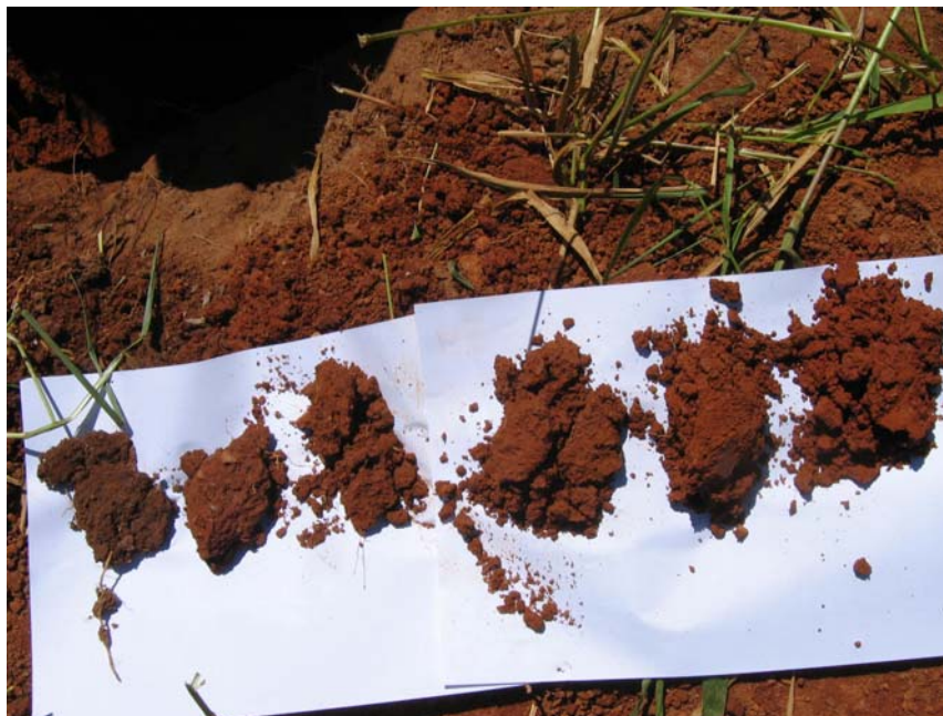
Figura 10a – Amostras dos horizontes do solo para determinação da cor. A partir da esquerda, profundidades de 0-18; 18-29; 29-51; 51-75; 75-130 e 220-240 cm.
