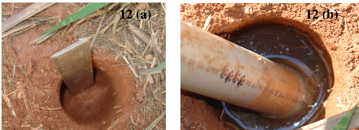
Figura 12 (a) e (b) – Detalhe do furo de trado utilizado para realização dos testes de condutividade hidráulica – (a) Mostra a carga hidráulica de 5 cm, enquanto (b) a carga hidráulica foi de 10 cm.
