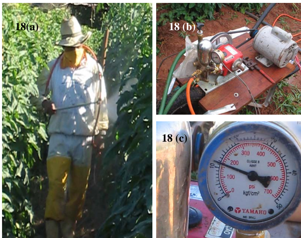
Figura 18 - Produtor vestido com equipamento de proteção individual (a), equipamento para pressurização de defensivos (b), pressão de serviço – perto de 160 psi, (c).
