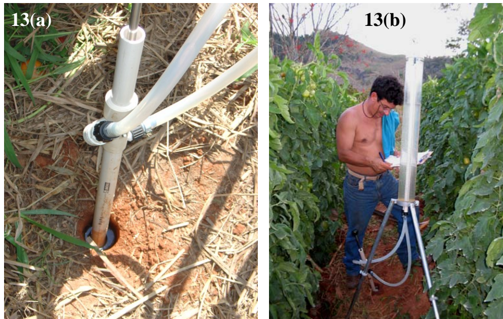
Figura 13 (a) e (b) – Detalhes do “Permeâmetro de Guelph Modificado” no teste em execução (a) e Vista Geral do Permeâmetro no local dos testes (b).
