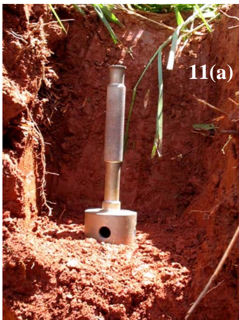
Figuras 11 (a) e (b) – Detalhe da coleta de amostra indeformada e da divisão de horizontes no perfil do solo.
