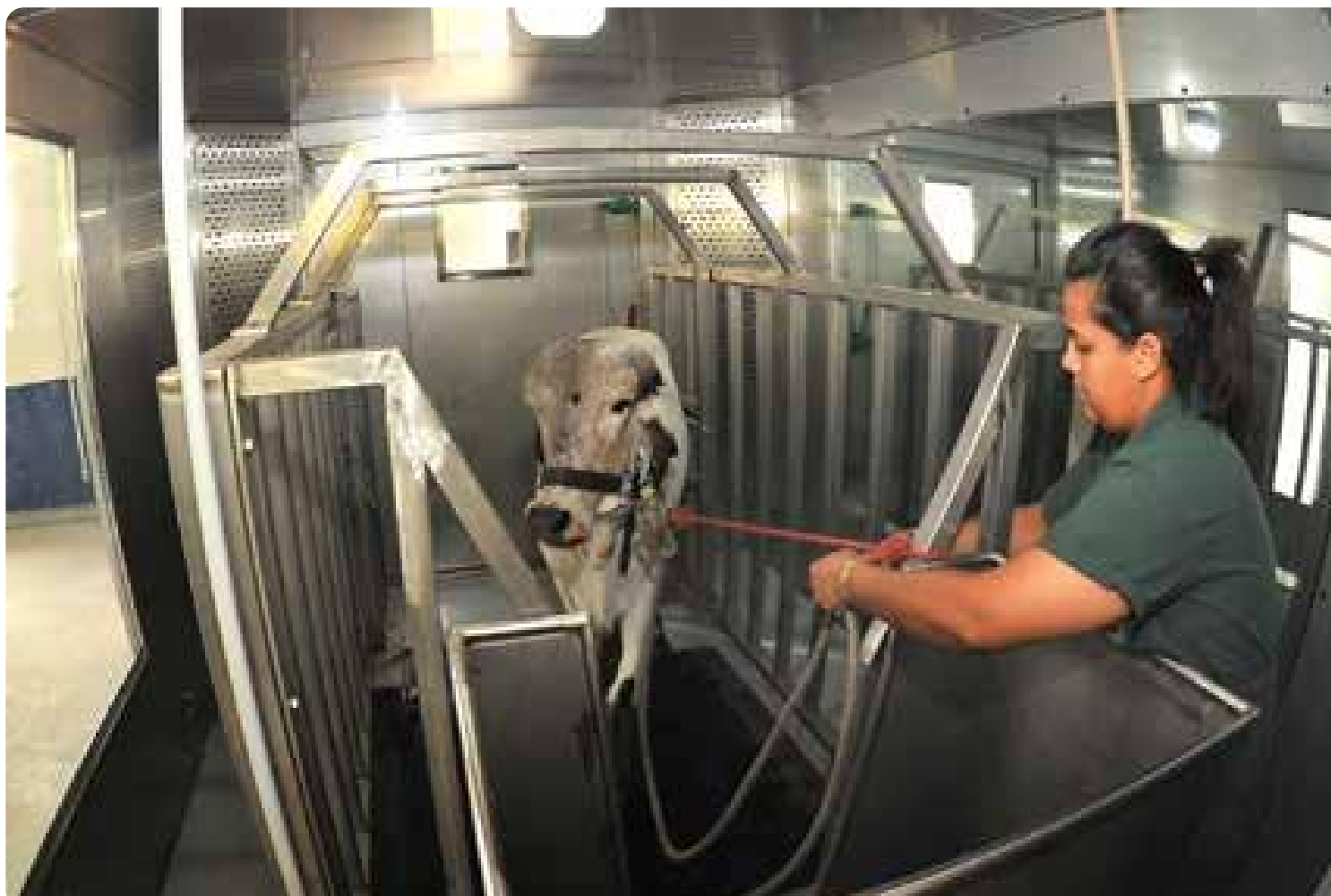
Foto 5A. Câmaras respirométricas da unidade experimental da Embrapa Gado de Leite de Coronel Pacheco/MG.
