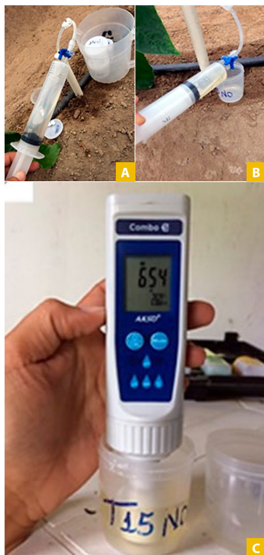
Figura 11.4. Extração da solução do solo (A), soluções armazenadas em recipientes conforme os tratamentos (B) e medição de pH, condutividade elétrica, salinidade e sólidos totais dissolvidos (TDS) com medidor multiparâmetro portátil (C).
