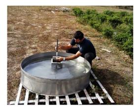
**Figura 10.9**. Aferição do volume de água evaporado em Tanque Classe A, para manejo da irrigação no Nordeste Paraense.
