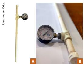
**Figura 10.8**. Tensiômetro com vacuômetro para aferição da tensão crítica de água no solo.
