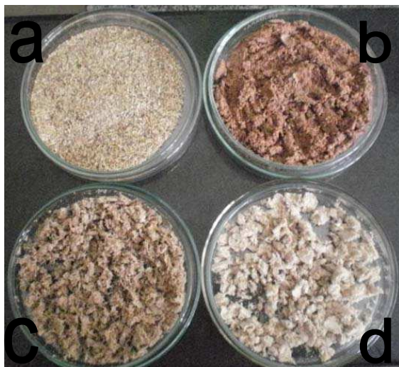
Figura 4.16 – Imagem dos materiais utilizados na sacarificação enzimática. a - palha de sorgo forrageiro moída in natura ; b - polpa pré-tratada por ácido diluído (5%) por 15 min. a 120 °C; c - polpa pré-tratada por ácido base (5%) por 15 min. a 120 °C; d - polpa pré-tratada por ácido diluído (5%) por 15 minutos a 120 °C seguido por deslignificação básica (5%) por 15 min. a 120 °C.
