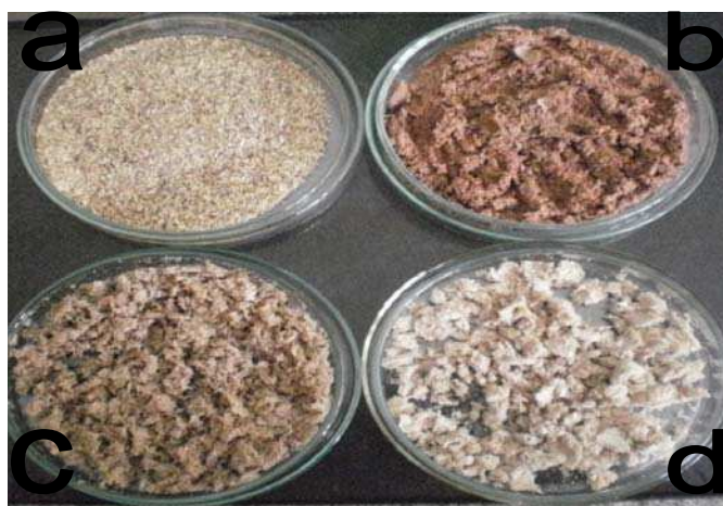
Figura 3.4 – Imagem dos materiais utilizados na sacarificação enzimática. a - palha de sorgo forrageiro moída não tratada; b - polpa pré-tratada por ácido diluído (5%) por 30 min. a 120 °C; c - polpa pré-tratada por álcali (5%) por 30 min. a 120 °C; d - polpa pré-tratada por ácido diluído (5%) por 30 min. a 120 °C seguido por deslignificação básica (5%) por 30 min. a 120 °C.
