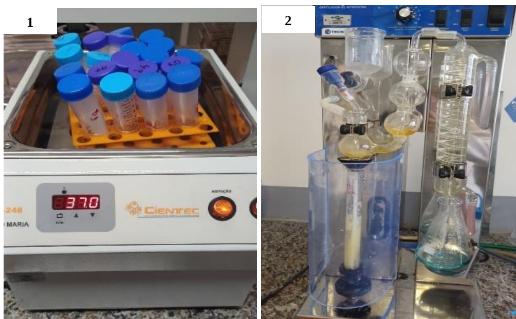
Figura 7. Etapa de digestão enzimática em banho-maria (1) e etapa de destilação de nitrogênio (2).
