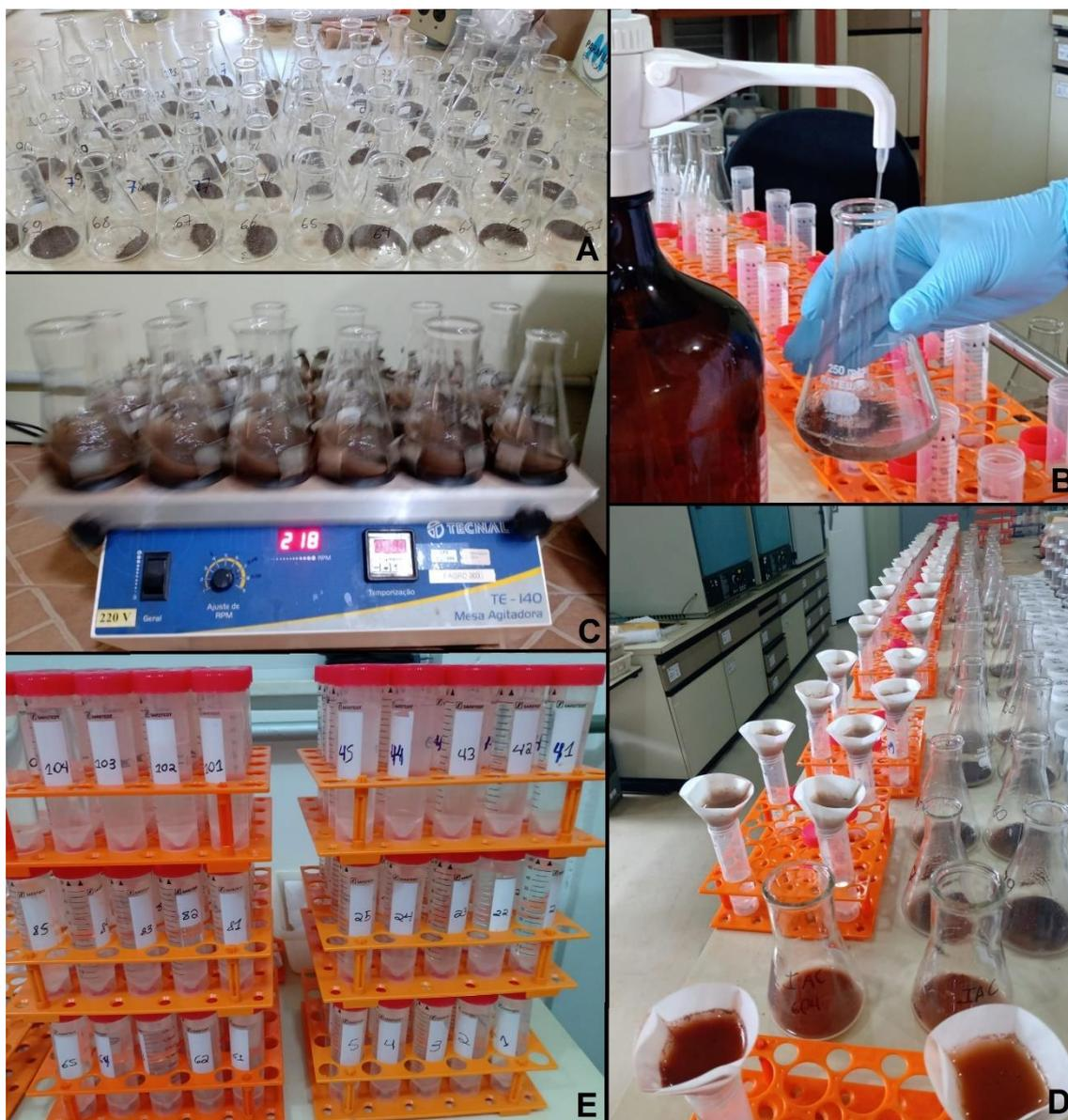
**Figura 4.** Etapas para a extração de cálcio e magnésio trocáveis visando a avaliação da reação de calcários no solo: pesagem do solo para dentro de Erlenmeyer (A), adição de solução extratora de cloreto de amônio (B), agitação por 15 min a cerca de 200 rpm (C), filtração do extrato (D), e amostras de extrato acondicionados em tubos até o momento da análise (E).
