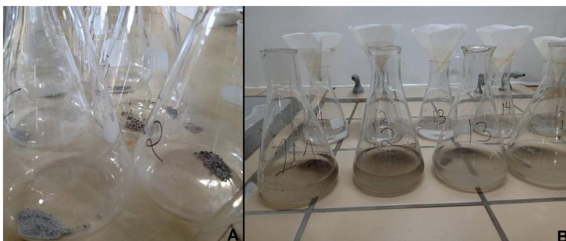
**Figura 5.** Etapas de pesagem (A) e filtração (B) no método para determinação da solubilidade de corretivos de acidez usando-se solução de ácido acético 1%.
