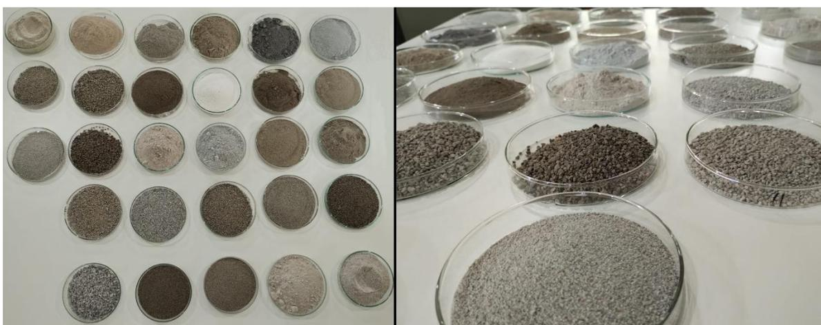
**Figura 1.** Materiais em placas de petri, evidenciando diferentes granulometrias e cores.
