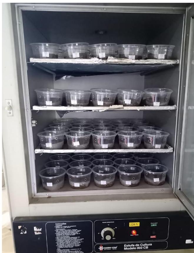
**Figura 3.** Amostras de solo incubadas com calcário colocadas para secar em estufa a 40°C, em cada tempo de avaliação.
