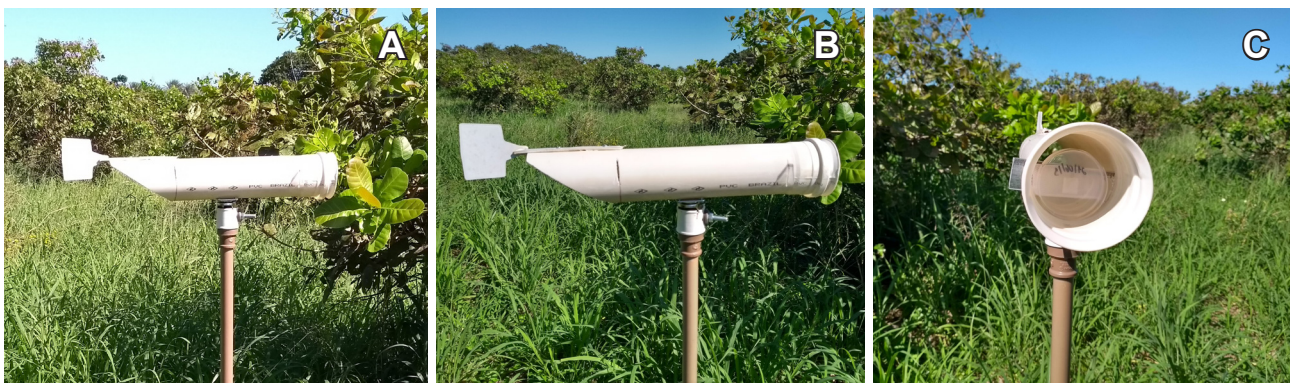
Figura 1. Armadilha para captura de conídios de Erysiphe quercicola disposta no pomar de cajueiro-anão 'BRS 189' em Pacajus, CE. Vista da armadilha dentro do pomar (A); visão aproximada da armadilha com leme (B); visão frontal (interior) da armadilha com a lâmina para a captura dos conídios do fungo (C).
