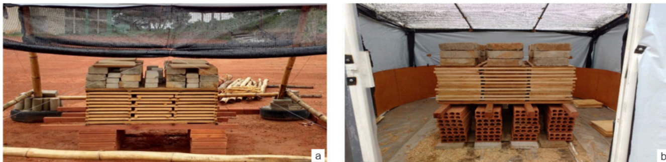
Figura 3. Pilhas de secagem instaladas nas adjacências do Laboratório de Tecnologia e Utilização de Produtos Florestais da Universidade Federal do Tocantins (UFT), no município de Gurupi, Tocantins.
