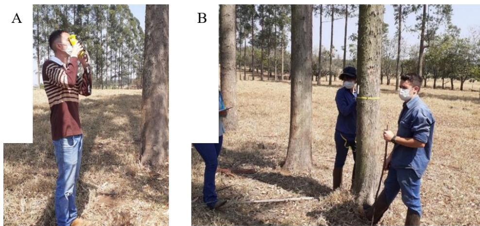
Figura 4. Medição de altura de árvore de eucalipto na área de estudo utilizando o hipsômetro (A) e do diâmetro à altura do peito (DAP) (B) de árvore de eucalipto na área de estudo.
