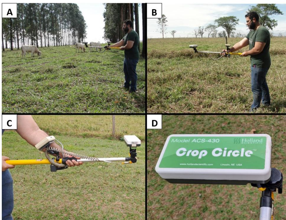
**Figura 1.** Medição de índices de vegetação em pasto de capim Piatã sombreado por árvores de eucalipto (*Eucalyptus urograndis* clone GG100) (A) e a pleno sol (B) em São Carlos, SP. Detalhes do aparelho ACS-430 Crop Circle (Holland Scientific, Lincoln, NE, USA) utilizado para medição dos índices de vegetação (C e D).
