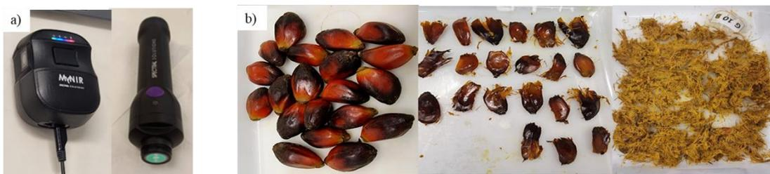
Figura 1: a) Espectrômetros de Infravermelho Próximos (NIR) portáteis NIR-S-G1 e MicroNIR; b) Fruto fresco da palma de óleo, “tampa” e polpa seca.
