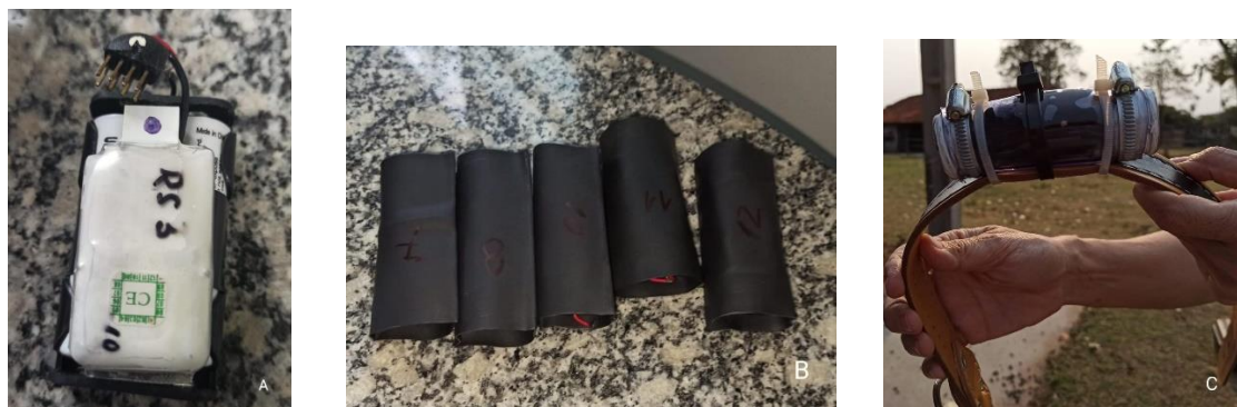
Figura 3. Processo de montagem dos GPS's. (A) Dispositivos já montados e acoplados na bateria. (B) Dispositivos envoltos com revestimento termorretrátil. (C) Equipamento montado pronto para serem colocados nos animais.
