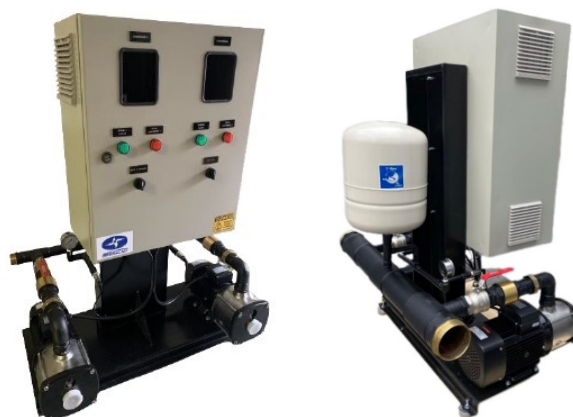
Figura 8. Sistema de inversores de frequência aplicado em duas bombas que podem ter a velocidade de funcionamento variável e operarem em conjunto, alternadamente ou individualmente.
