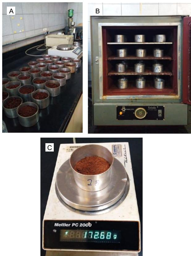
**Figura 2.2.** Etapas para a determinação da densidade do solo. (A) Amostras transferidas para recipientes metálicos, (B) Secagem, (C) Pesagem.
