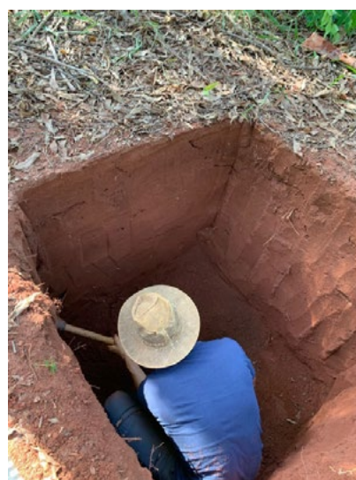
Figura 1.8. Limpeza das paredes da minitrincheira para a coleta das amostras de solo.
