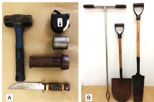
Figura 1.4. Relação de alguns materiais necessários para a coleta. (A) Faca, marreta, castelinho/batedor, anel, fita métrica/trena; (B) Trado holandês, pá, pá reta ou de corte.
