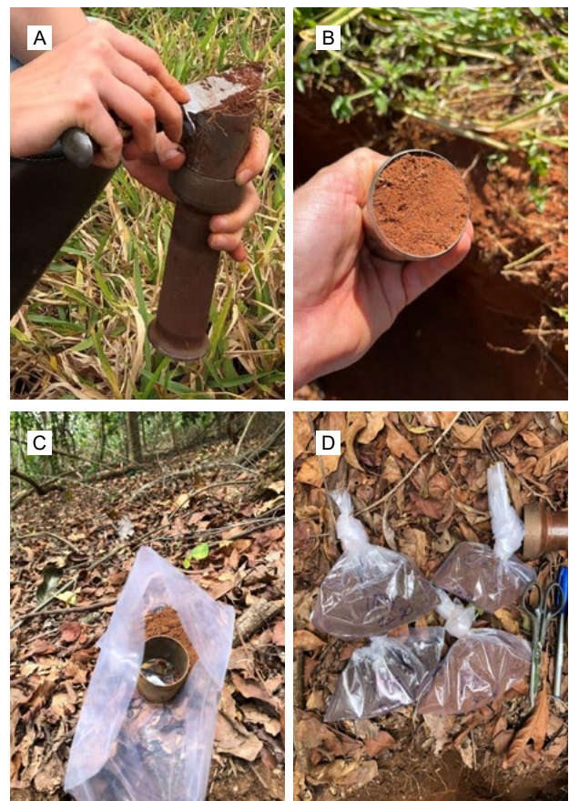
Figura 1.11. Amostra de solo no anel para a densidade do solo. (A) Limpeza do anel, (B) Anel pronto, (C) Retirada da amostra de solo, (D) Sacos com as amostras de solo de cada camada.
