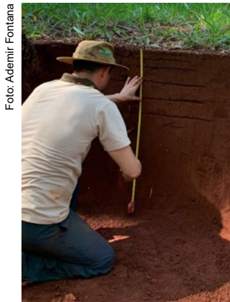
Figura 1.9. Marcação das camadas com trena ou fita métrica na minitrincheira para a coleta da densidade do solo.
