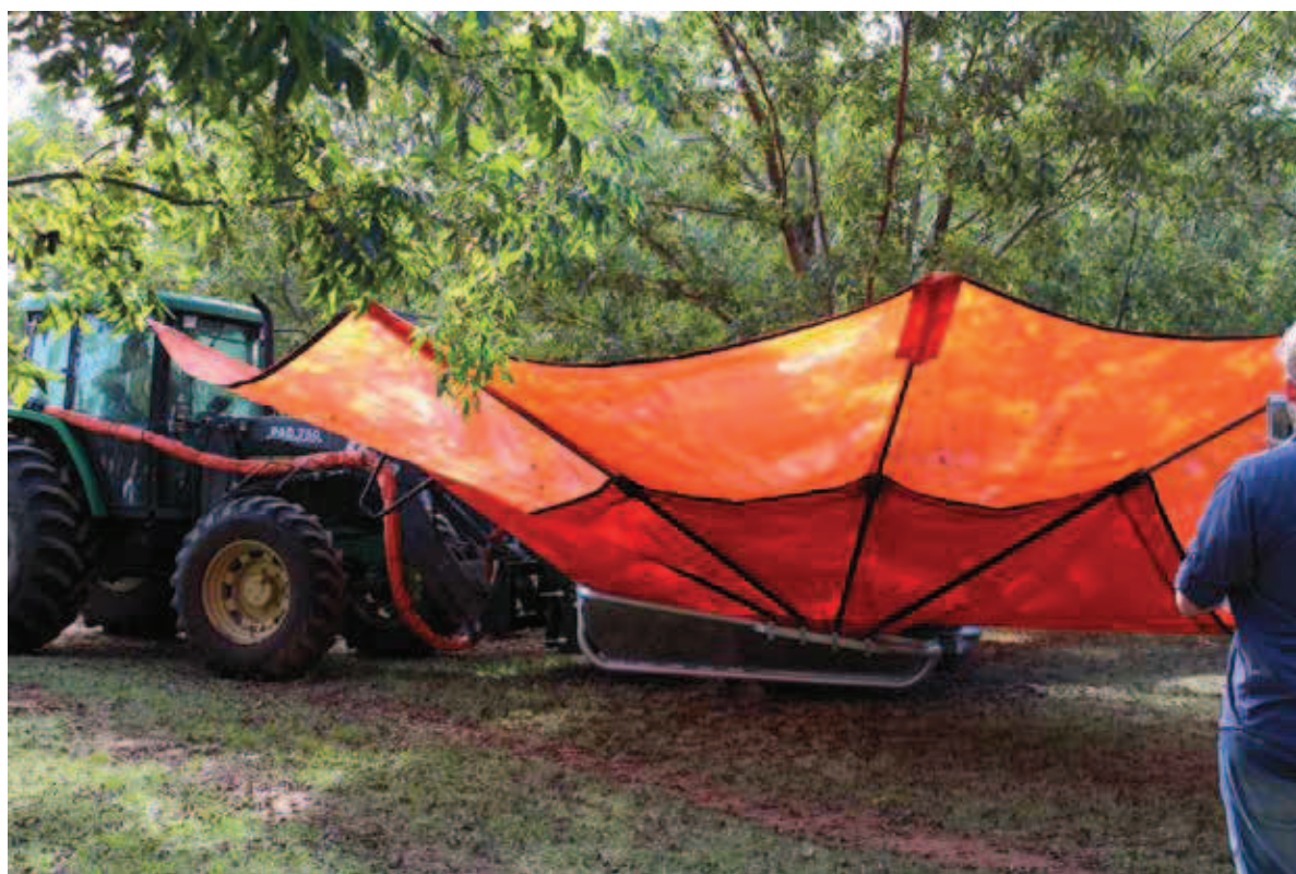
Figura 10. Agitador-colhedora tipo “guarda-chuva invertido” utilizado no processo de colheita de noz-pecã.
