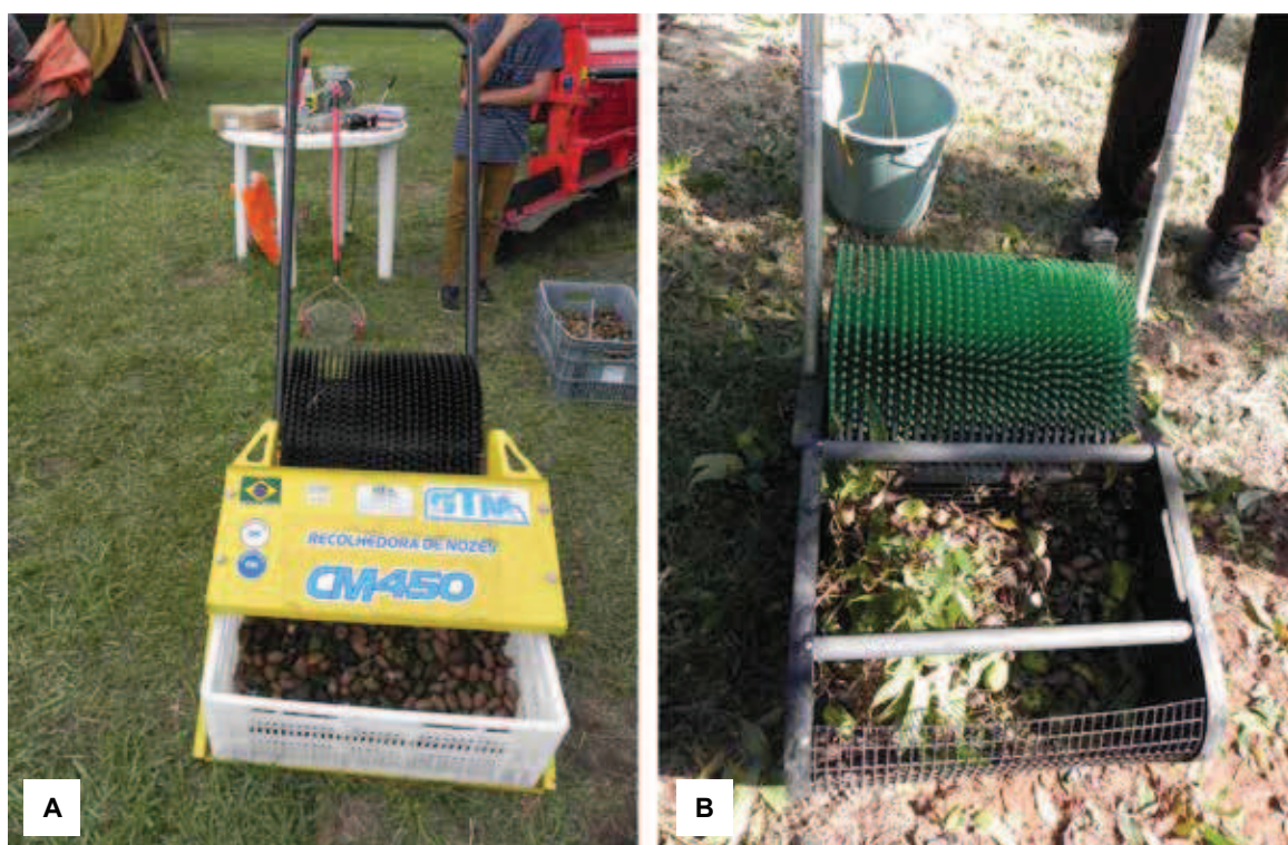
Figura 7. Recolhedor de nozes para colheita manual: modelos (A; B) comercializados no Brasil.
