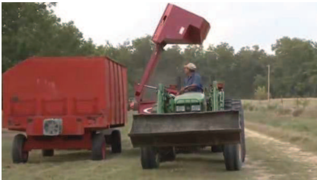
Figura 12. Colhedora lateral acoplada utilizada na operação de descarga das nozes-pecã colhidas.
