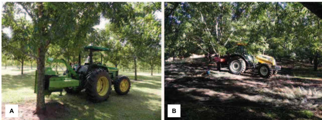
Figura 8. Tratores equipados com agitador de tronco, conhecido como shaker , para desprender as nozes diretamente ao solo (A) e a sombrite sobre o solo (B).
