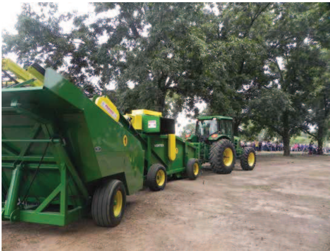
Figura 16. Trator equipado com recolhadora de nozes e separador de folhas, ramos e resíduos.
