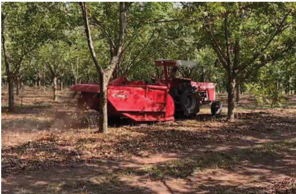
Figura 11. Colhedora lateral acoplada utilizada na operação de colheita de noz-pecã.
