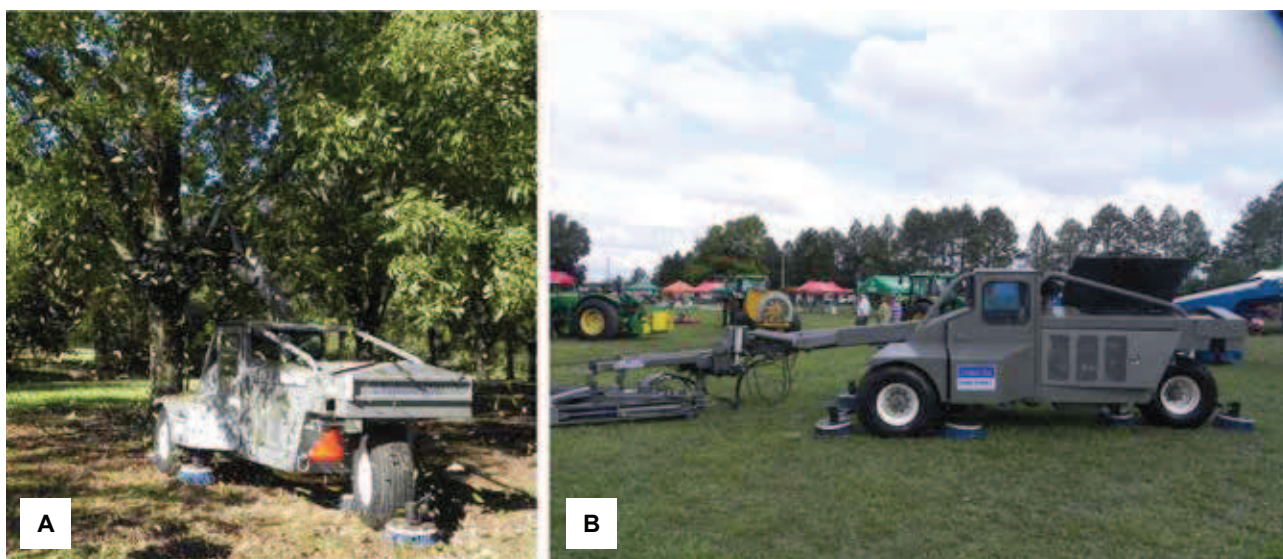
Figura 13. Colheita mecanizada de noz-pecã (A) com agitadores autopropulsados de tronco (B).
