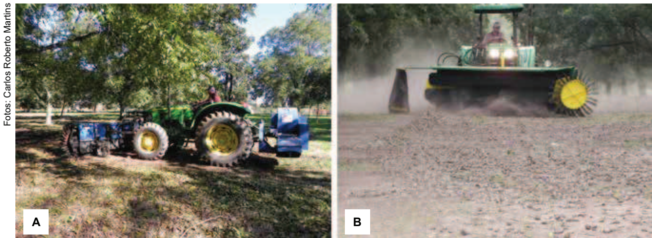
Figura 14. Recolhimento de nozes caídas no chão do pomar (A) utilizando trator equipado com vassouras na dianteira e sopradores na traseira (B).
