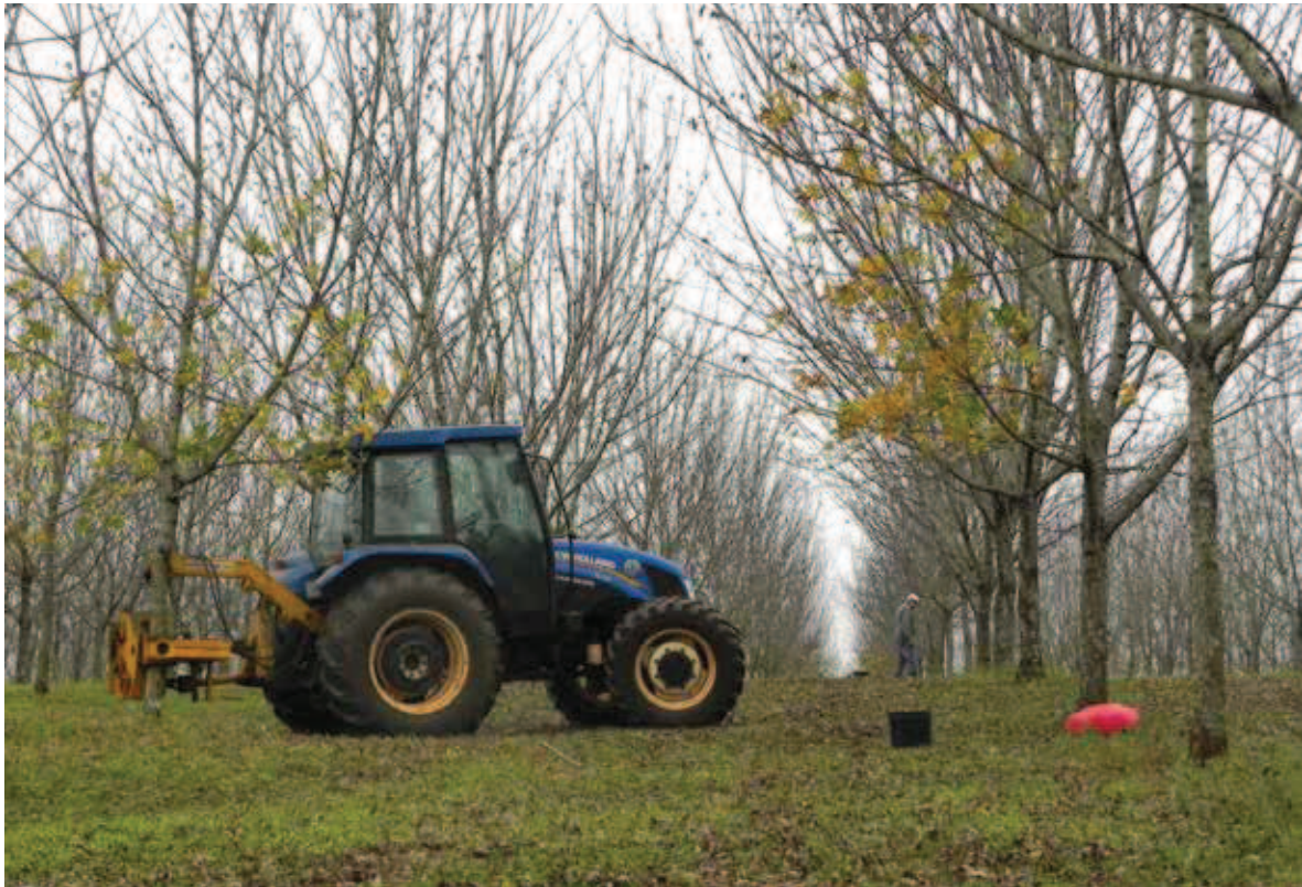
Figura 9. Colheita de nozes em segunda passagem usando o agitador de tronco ( shaker ) em pomar de nogueira-pecã no município de Santa Rosa, RS.
