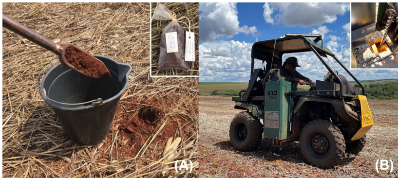
Figura 18. Coleta manual de solo com trado holandês e identificação da amostra do talhão (A), e coleta com quadriciclo, com destaque para o mecanismo de coleta utilizando broca de acionamento hidráulico (B).
