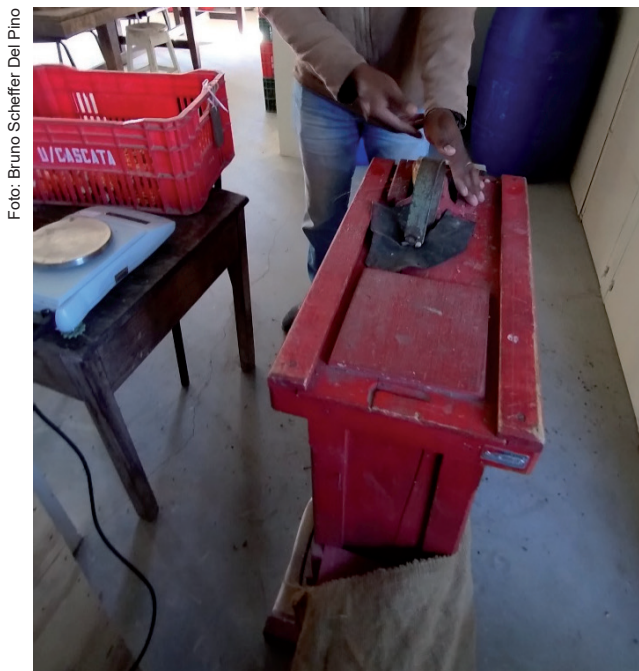
Figura 10. Debulhadora utilizada para retirada dos grãos de milho da espiga.
