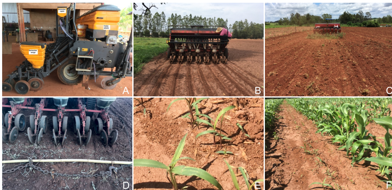
Figura 4. Semeadoras com caixa adicional para sementes miúdas (A e B) e incorporação auxiliar de sementes (C e D), com emergência de plântulas de capim (E) e sorgo (F).
