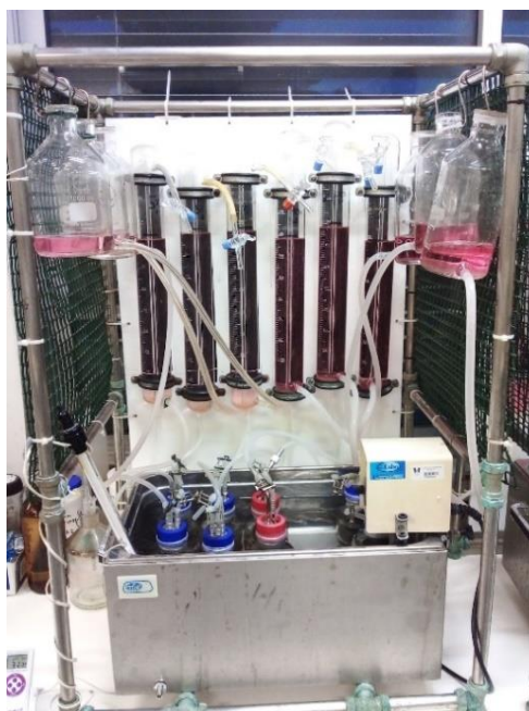
Figura 1 – Montagem experimental dos reatores anaeróbios em co-digestão.
