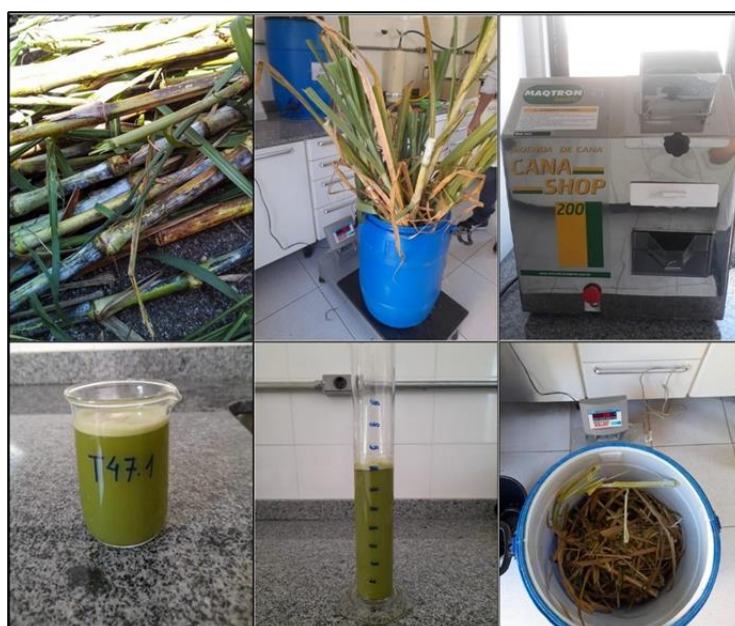
Figura 2 – a) Os genótipos separados e identificados; (b) mediu-se o peso de dez plantas inteiras de cada genótipo; (c) moinho semi-industrial com rolos de aço inoxidável; (d) foi coletado caldo; (e) medição do volume (em mL); e (f) mediu o peso dos resíduos de biomassa do bagaço prensado.
