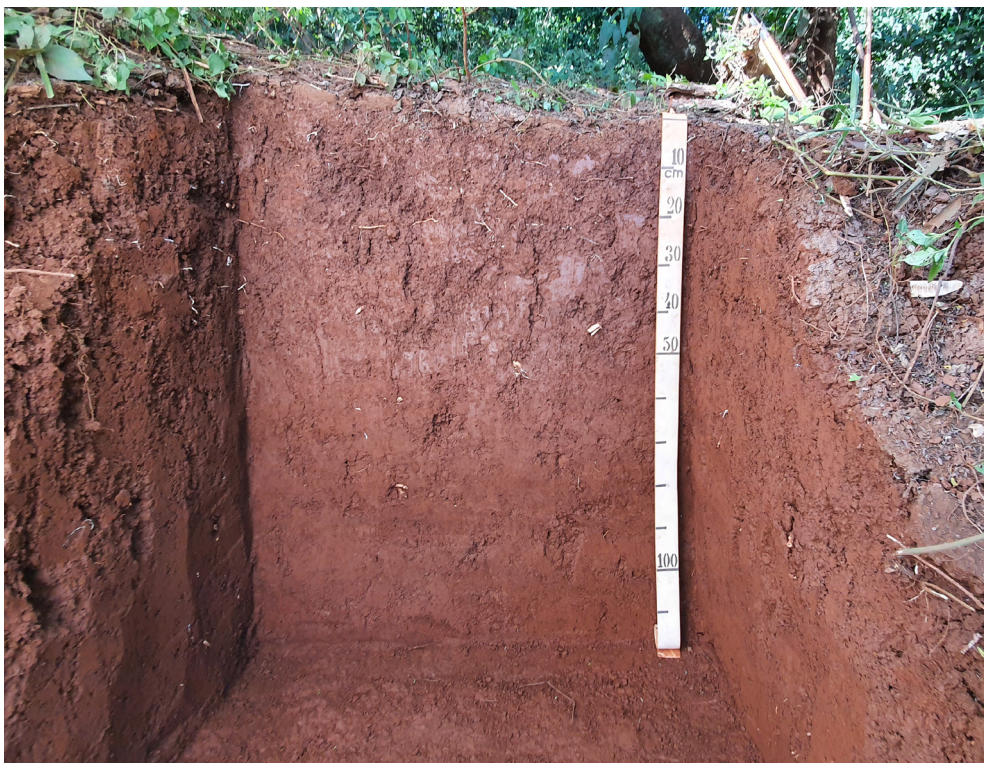
Figura 6. CAMBISSOLO FLÚVICO Tb Distrófico típico, A proeminente, textura muito argilosa – Registro do PronaSolos PR.
