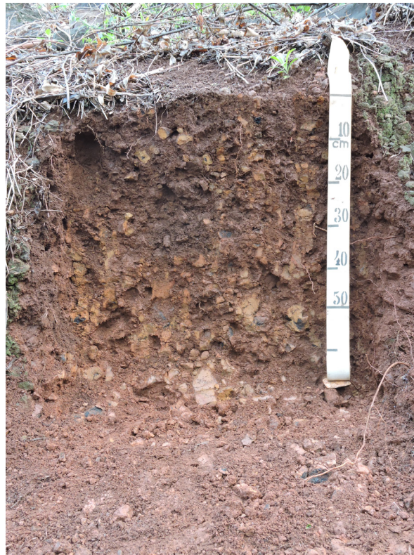
Figura 10. NEOSSOLO REGOLÍTICO Eutrófico leptofragmentário, A moderado, fase erodida, textura média calhenta pedregosa ligeiramente rochosa – Registro do PronaSolos PR.
