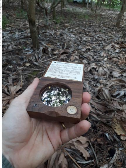
**Figura 12.** Densiômetro de copa em uso no experimento, no interior da parcela amostral de 25 x 2 m.
