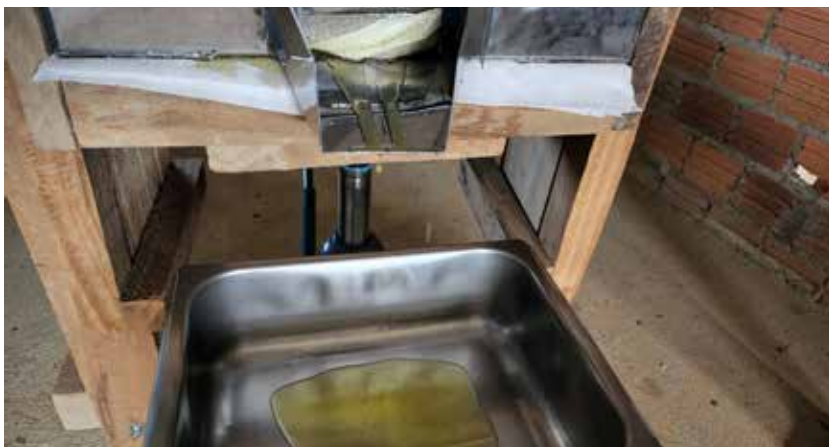
Figura 8. Proceso de drenaje del aceite después del prensado en frío.
