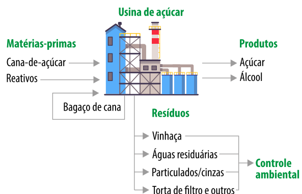
Figura 10.1. Produção de resíduos decorrente da produção de açúcar e álcool por usina de açúcar com destilaria anexa.
