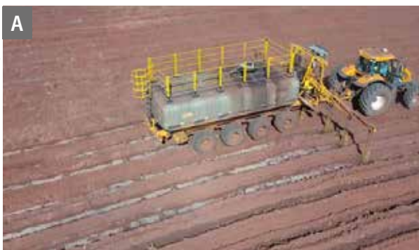
Figura 10.9. Aplicação localizada de vinhaça com trator (A) e transferência da vinhaça do caminhão para o tanque do trator (B).
