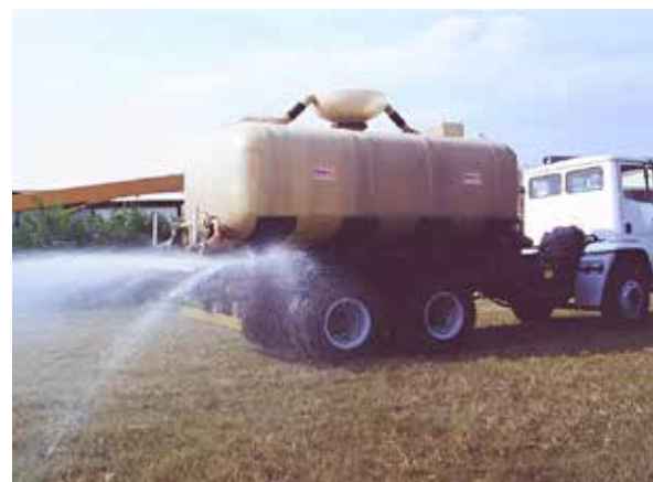
Figura 10.6. Distribuição da vinhaça por meio de caminhão-tanque/aplicadora.
