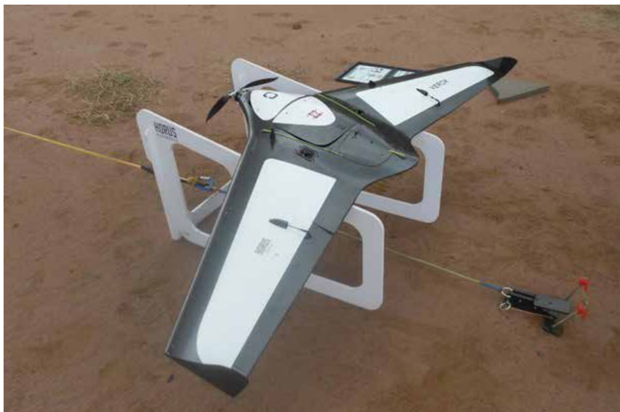
Figura 12.5. Aeronave remotamente pilotada (ARP), modelo Verok Horus, com autonomia de até 2 horas e cobertura até 4.300 ha.
