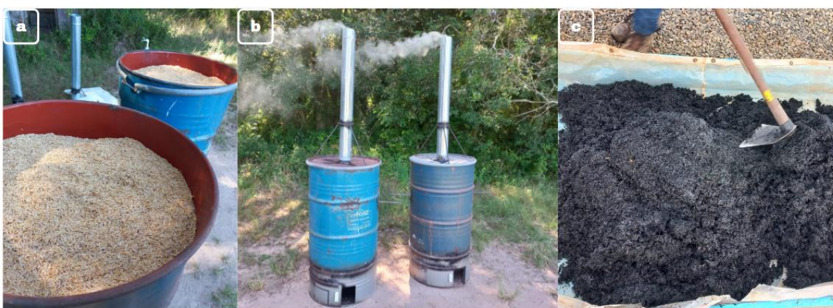
Figura 4: Carbonização da casca de arroz em carbonizador artesanal
