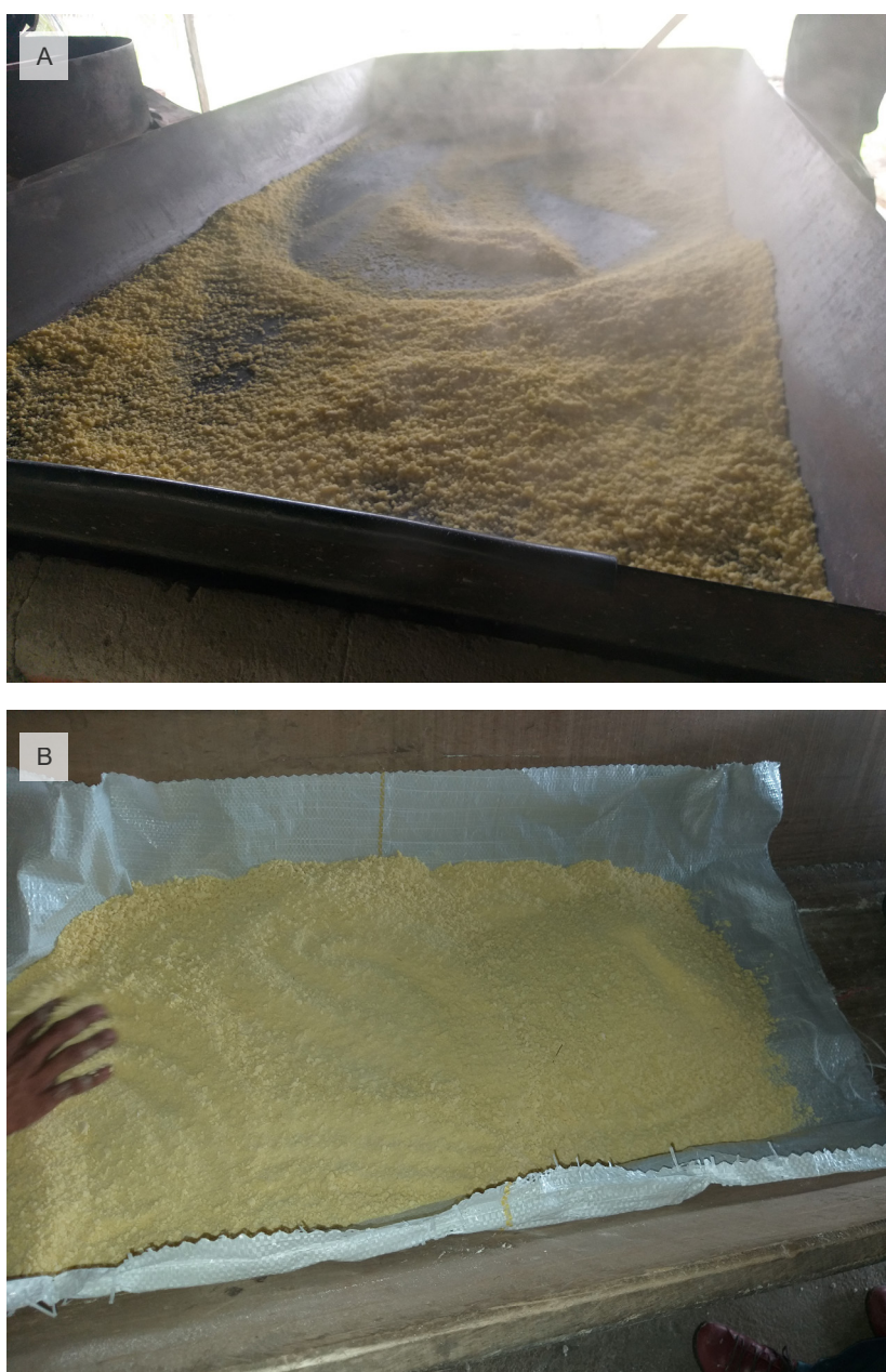
Figura 1. Processo de fabricação de farinha de mandioca seca: tostagem em forno tradicional (A) e resfriamento em gamelas de madeira (B).
