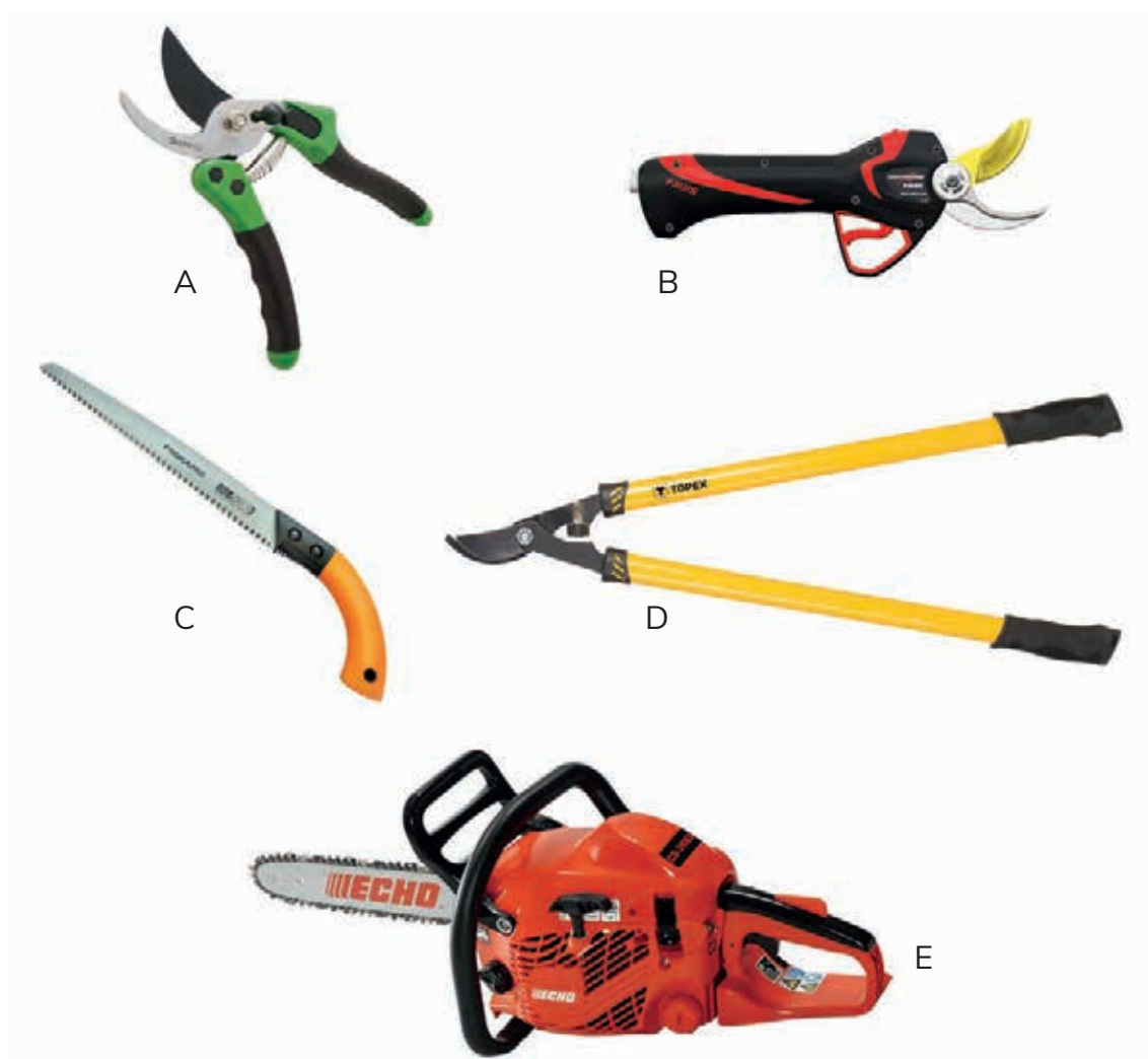
Figura 1. Ferramentas recomendadas para poda de erva-mate: (A) tesoura de poda; (B) tesoura de poda elétrica; (C) serrote de poda; (D) podão; e (E) motosserra.
