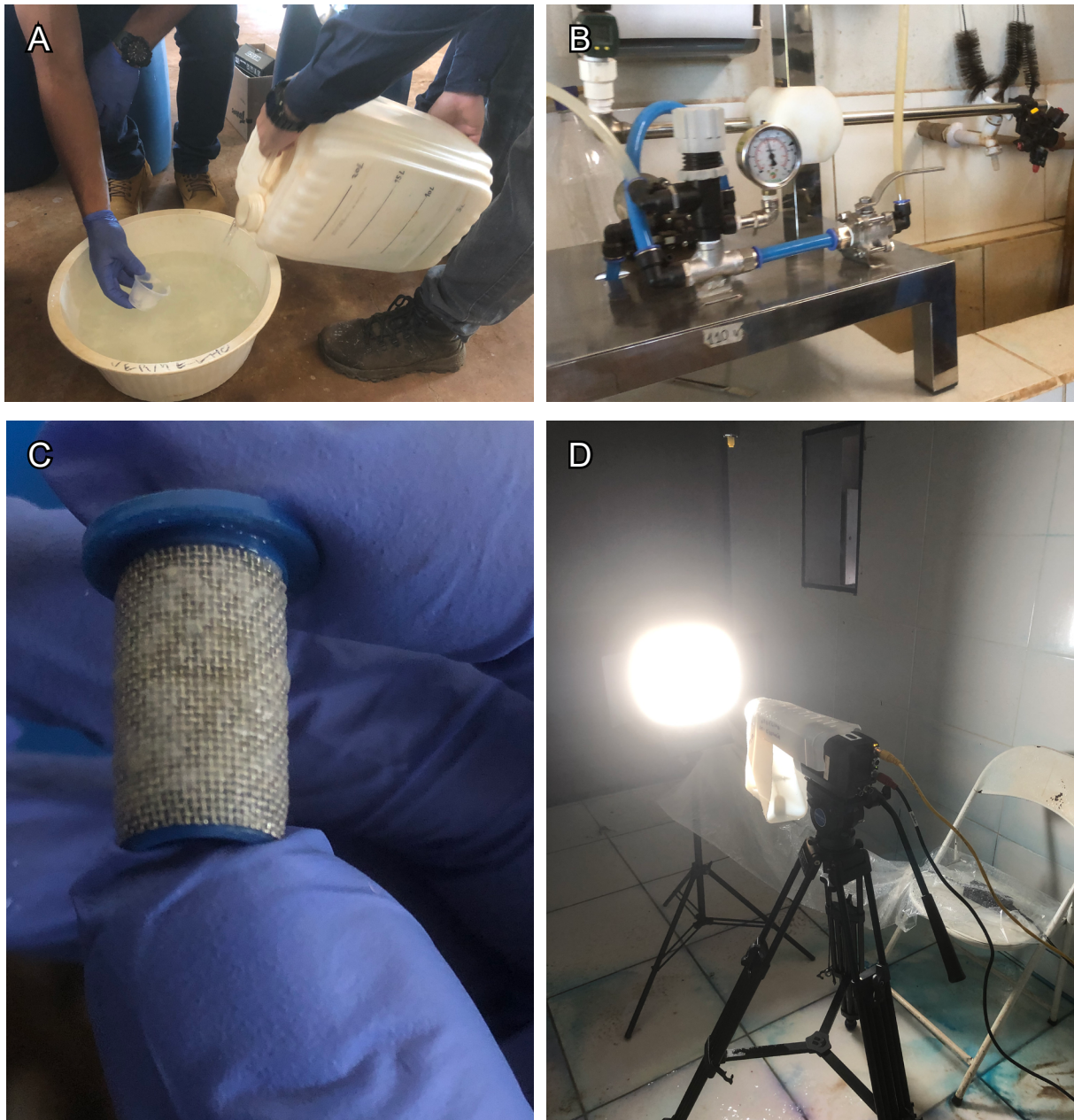
Figura 18. Nanocelulose em pulverização para controle de plantas daninhas: (A) diluição da nanocelulose; (B) pulverizador de bancada; (C) filtro de bico do pulverizador com nanocelulose retida; (D) aparato (lâmpada de luz branca e câmera de alta resolução e velocidade) para realizar o espectro de gotas. Teste realizado no Núcleo de Investigação em Tecnologia de Aplicação e Máquinas Agrícolas da Universidade Estadual do Norte do Paraná.
