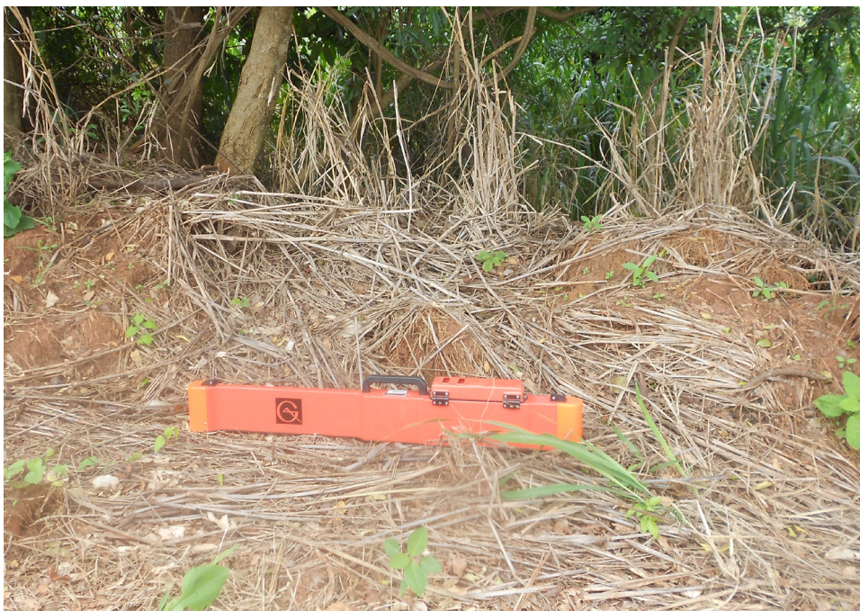
Figura 2. Sensor de indução eletromagnética EM38®. Fazenda Pamplona, Cristalina, GO.
