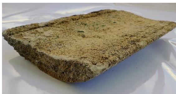
Figura 1. Imagem de estruvita natural removida de tubulação de uma unidade de tratamento de dejetos suínos.
