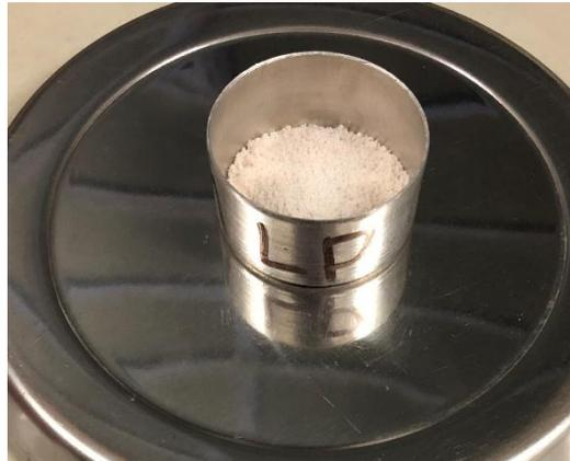
**Figura 1.** Cinza após o banho em ácido clorídrico.
