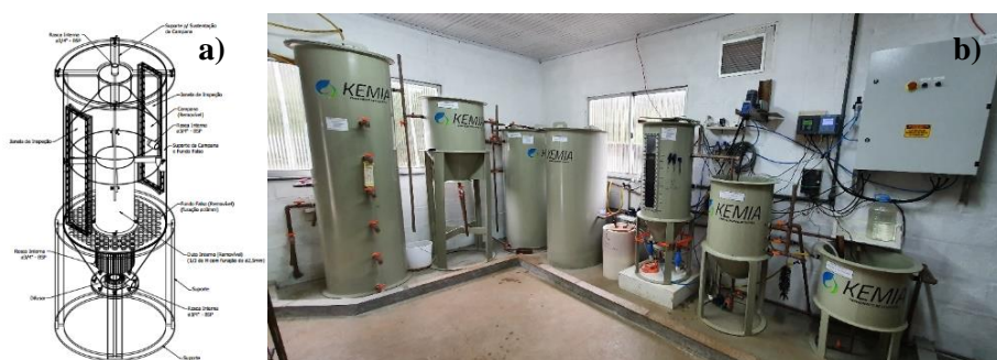
Fig. 1. a) Desenho do reator piloto. b) Imagem do aparato experimental em operação.
