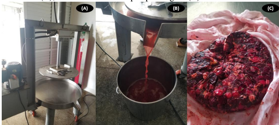
Figura 7: Prensa hidráulica utilizada (A); etapa de prensagem para preparo do mosto de acerola do tratamento T2 (B); resíduo de acerola após prensagem (C).
