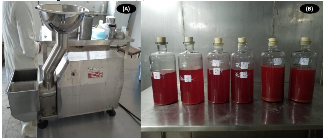
Figura 6: Elaboração da polpa de acerola em despulpadeira (A); mostos de acerola após o processo de debourbage do tratamento T1(B).
