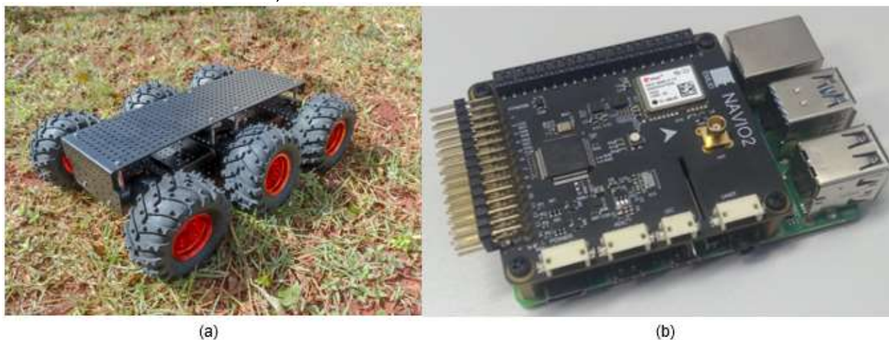
Figura 3. (a) Chassi Dagu Wild Thumper 6WD 75:1, (b) Navio2 conectado ao Raspberry Pi 4.
