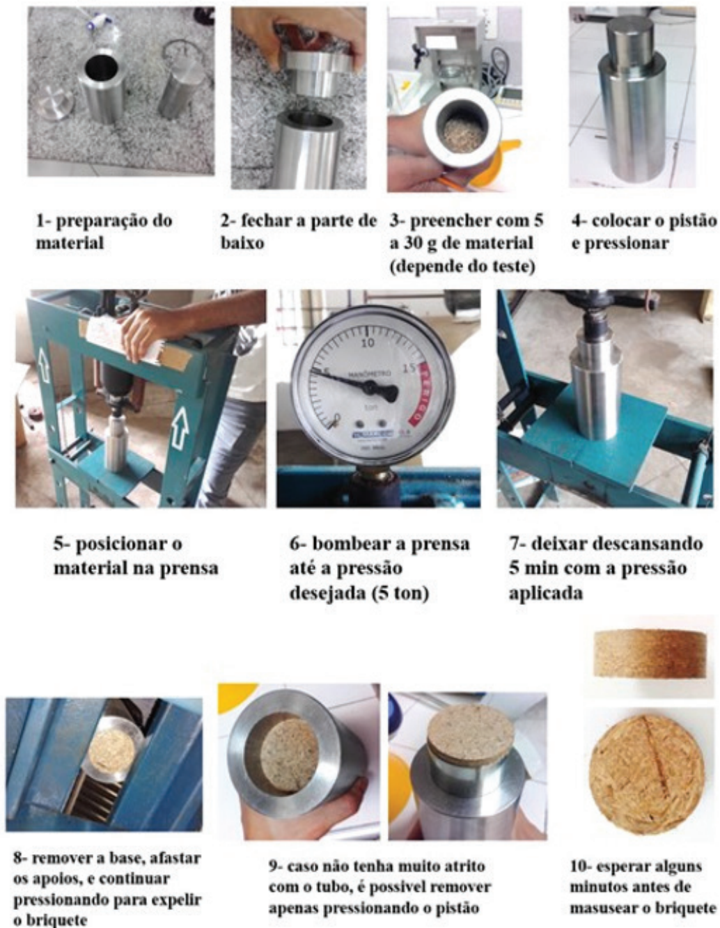
Figura 18. Etapas para utilização do molde briquetador.
