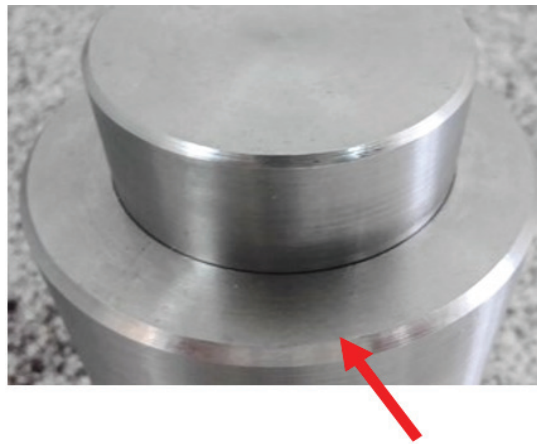
Figura 4. Chanfro adicionado ao pistão, para indicar o lado da peça que deve ser voltado para cima.
