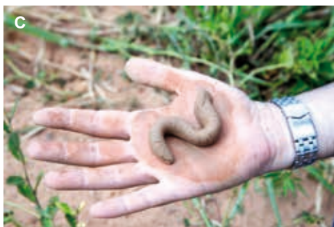
Figura 1. Teste da letra “S” para a identificação da textura do solo no campo: (A) arenosa (menos de 15% de argila); (B) média (de 15% a 35% de argila, ideal para a construção de viveiros); (C) argilosa (com mais de 35% de argila).
