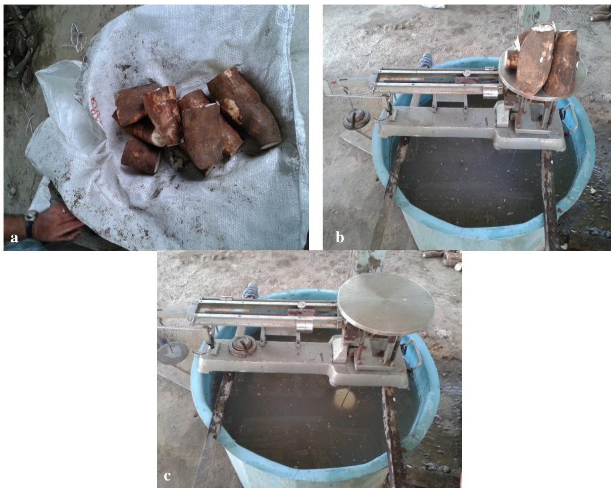
Figura 8. Amostras de raízes de mandioca lavadas (a), determinação da amostra de três quilos (b) e do peso em água das raízes de mandioca (c) da parcela experimental.
