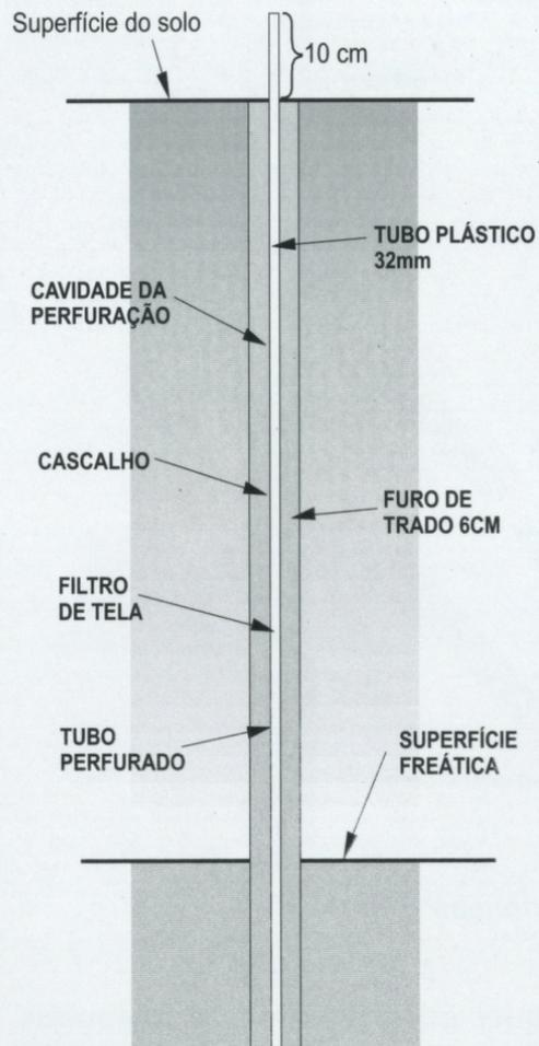
Fig. 3. Poço de observação
