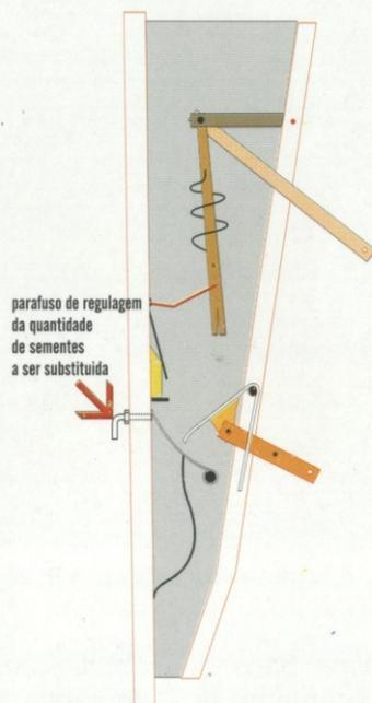
Fig. 5. Mecanismo distribuidor da semeadora Semeato, de tração motora utilizada na implantação de pastagens de capim buffel.
