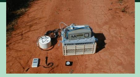
Sistema de câmara e medidor infravermelho usado na medição do fluxo de  ${\rm CO}_2$  do solo.
