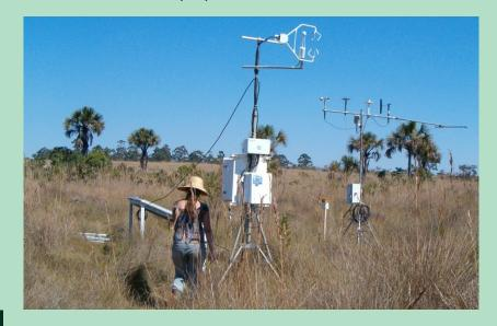
Sistema de Correlação dos Turbilhões para obtenção dos fluxos de CO<sub>2</sub> vegetação-atmosfera e Estação Meteorológica.
