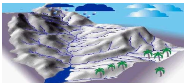
Figura 12. Ilustração de uma bacia hidrográfica mostrando os divisores de água, as sub-bacias e a drenagem principal (ANA, 2002).
