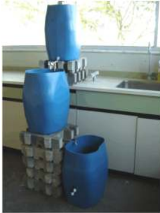
Fig. 27 Sistema simplificado de tratamento de água utilizando sementes da Moringa oleifera como coagulante/floculante natural seguido do filtro lento de areia.
