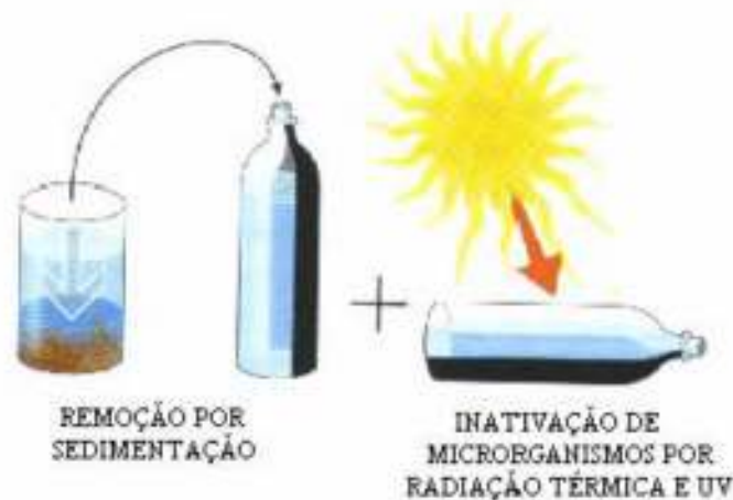
Fig. 8 Esquema do método da desinfecção por radiação solar. Fonte: PATERNIANI E ROSTON (2003)
