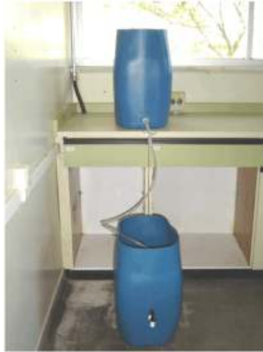
Fig. 21 Sistema simplificado de tratamento de água utilizando sementes da Moringa oleifera como coagulante/floculante natural.
