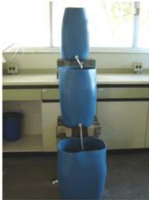
Fig. 24 Sistema simplificado de tratamento de água utilizando filtro lento de areia.
