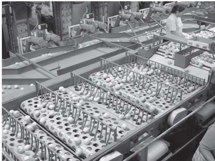
**Fig. 1:** Classificador de lonas utilizado para classificação de tomate de mesa.
