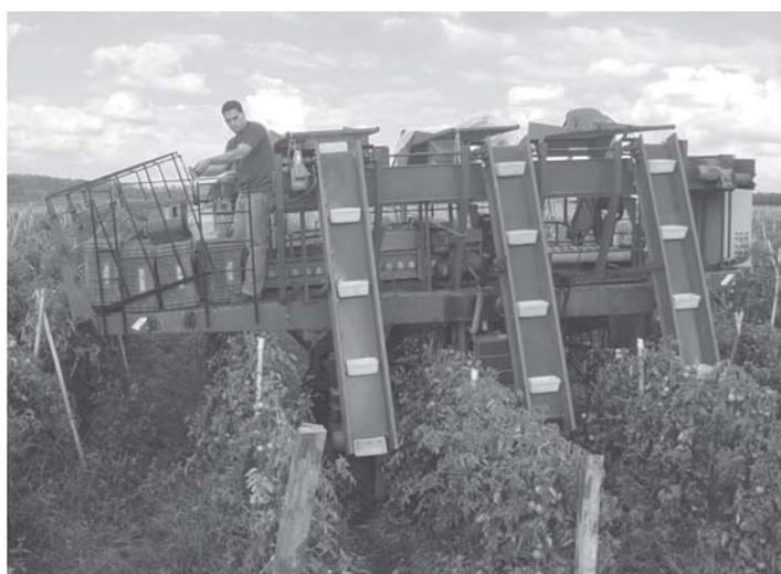
**Fig. 9:** Unidade Móvel de Auxílio à Colheita (UNIMAC) para tomate de mesa.
