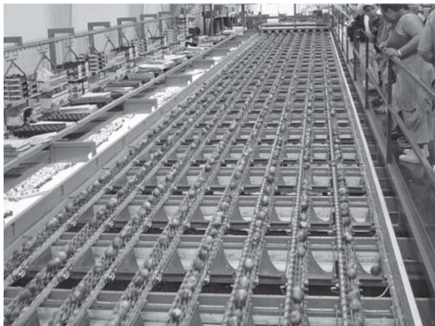
**Fig. 6:** Sistema de classificação eletrônico
