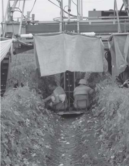
**Fig. 14:** Auxílio mecânico para colheita de tomate de mesa com acionamento hidráulico e velocidade continuamente variável por meio de bombas de deslocamento volumétrico variável
