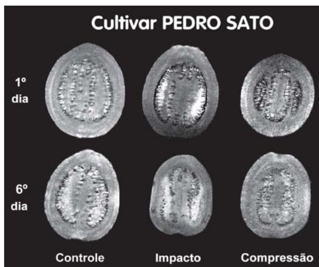
Fig. 6: Imagens tomográficas demonstrando alterações internas devido a forças externas de impacto e compressão. (BISCEGLI et al., 2002).
