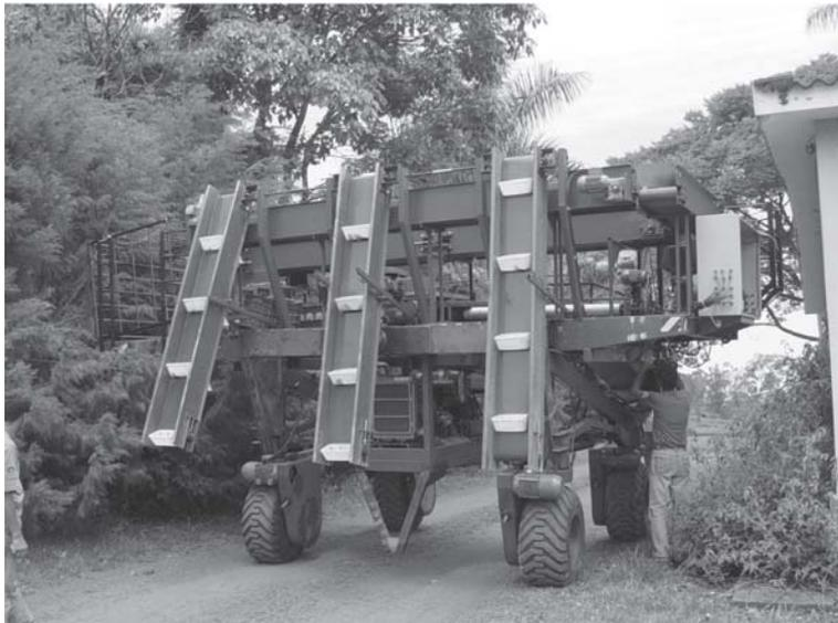
**Fig. 15:** Auxílio mecânico para colheita de tomate de mesa com acionamento elétrico e velocidade continuamente variável por meio de inversores de frequência nas quatro rodas.
