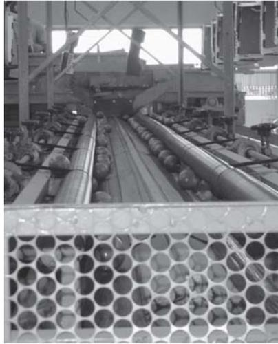
**Fig. 2:** Classificador em roletes longitudinais separando limões.
