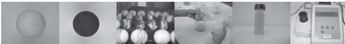
**Fig. 3:** Etapas para determinação do índice de limpeza com o turbidímetro, na seqüência de apresentação: esfera limpa, esfera suja, esferas no protótipo, lavagem manual/individual das esferas após passarem pelo protótipo, amostra da água de limpeza e turbidímetro de bancada. (Fotos: Ana Maria de Magalhães)
