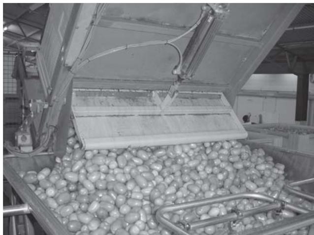
**Fig. 8:** Descarregamento de tomates por sistema basculante.
