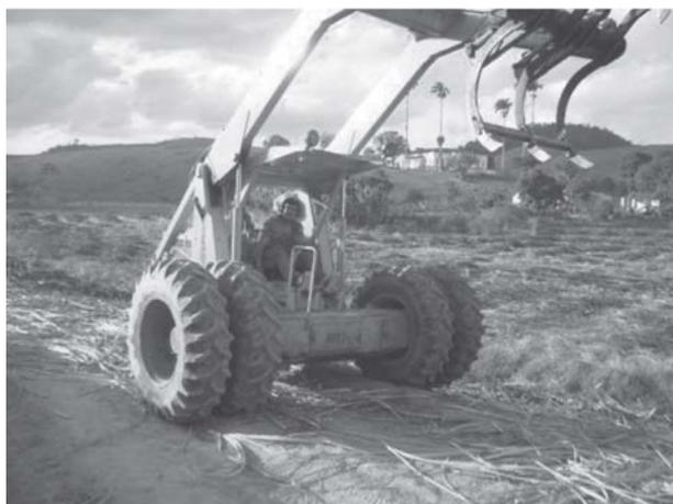
Fig. 4: Carregadora Implanor-Bell com bitola larga e centro de gravidade baixo, montada sobre pneus.
