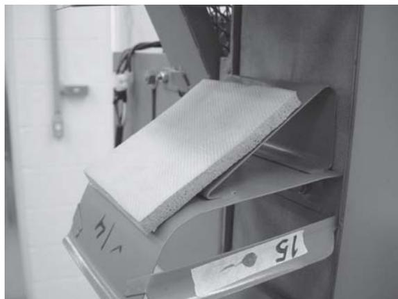
**Fig. 10:** Placa de borracha esponjosa de 9,5 mm, utilizada para amortização de impacto em pontos de transferência.
